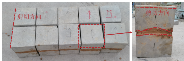
图6 制备完成的试件 Fig. 6 Preparing the specimen
