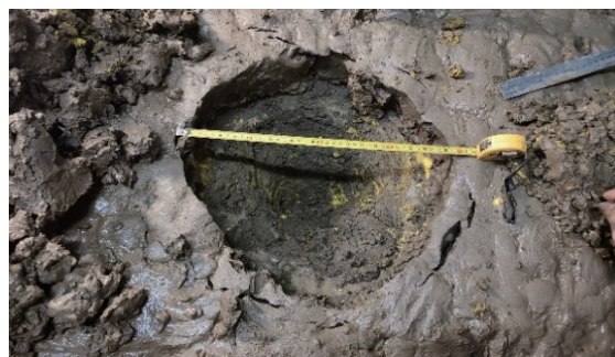
(b) 开挖揭露的漏斗状土洞
