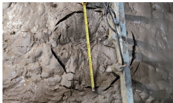
(a) 模型试验地面环状裂缝
