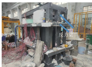
(a) 模型箱和反力架系统
