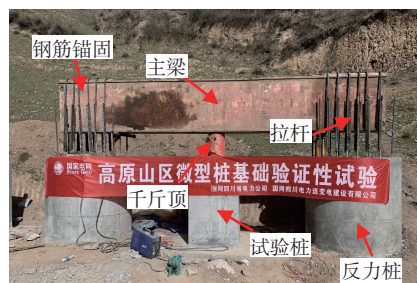
(c) 竖向静载试验装置
