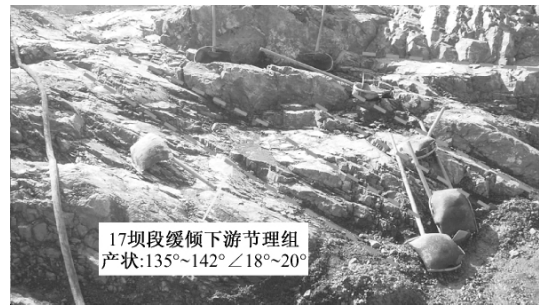
图3 坝段缓倾下游结构面典型照片
